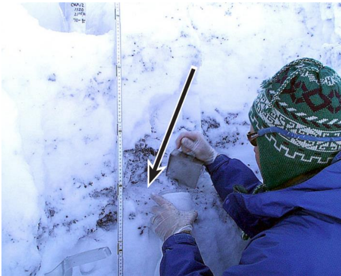
Abbildung 4-1: Sprengstoffrückstände einer künstlichen Lawinenauslösung in den USA, Foto: (Naftz et al. 2003)
